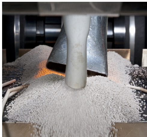
Bild 2: Unterpulverschweißung in der 2MN Prüfanlage
